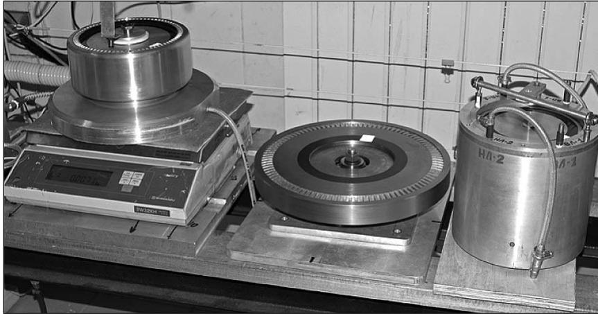
Рис. 19. Воздушные турбины и диск на подшипнике, использованные в экспериментах. Слева направо: турбина с внешним ротором массой 7,5 кг на весах BW32KH; диск весом 24 кг; турбина с внутренним 16 кг ротором
