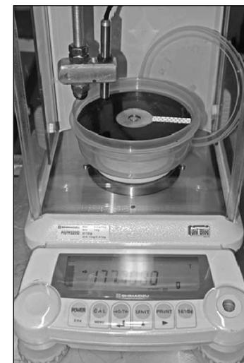
Рис. 18. Диск гироскоп весом 150 г в полиэтиленовом контейнере на весах, крышка от контейнера рядом; над диском датчик измерения скорости
