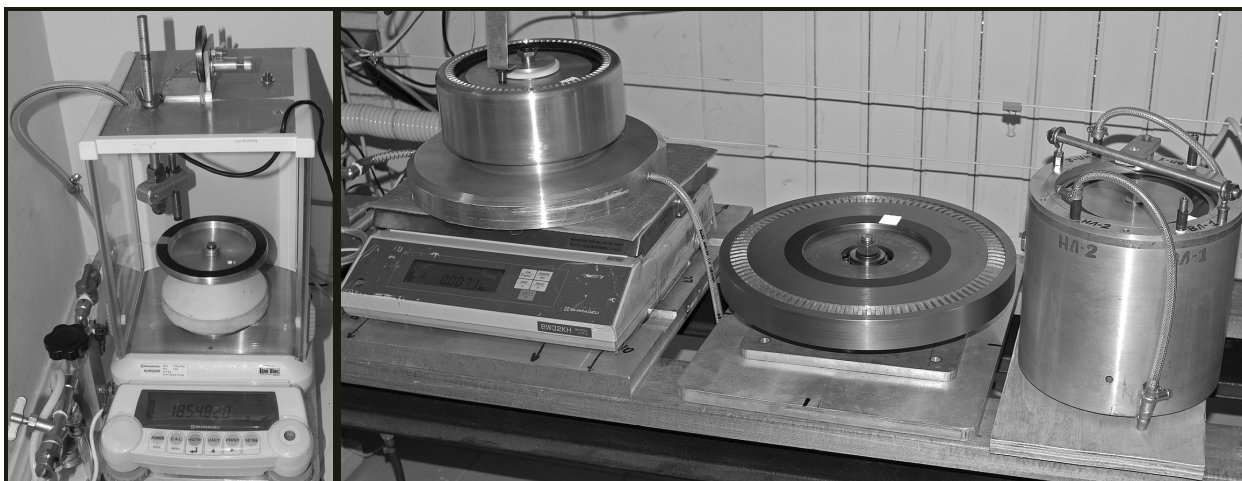
Рис. 2. Диски на подшипниках и воздушные турбины, использованные в экспериментах: а – диск массой 150 г. с подставкой в виде конуса из поролона на весах AUW220D; б – слева-направо: турбина с внешним ротором массой 7,5 кг на весах BW32KH; диск 24 кг на подшипнике; турбина с внутренним ротором
