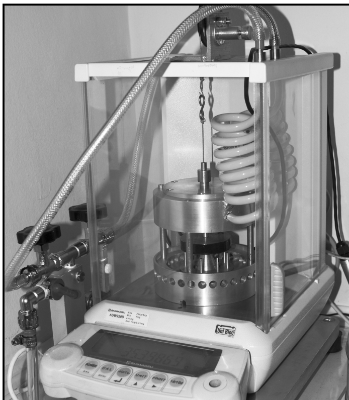
Рис. 1. Общий вид установки для измерения вариаций веса «игловых» гироскопов в воздушной среде (вращающийся гироскоп, окрашенный черной краской, виден внутри поднятой разгонной камеры)
